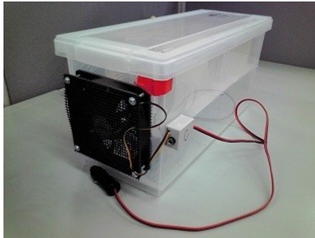
検体乾燥機（実地投入版） 最大 100 枚用 シガーライターソケット、外部電源（12V 1A AC/DC コンバーター）両用
