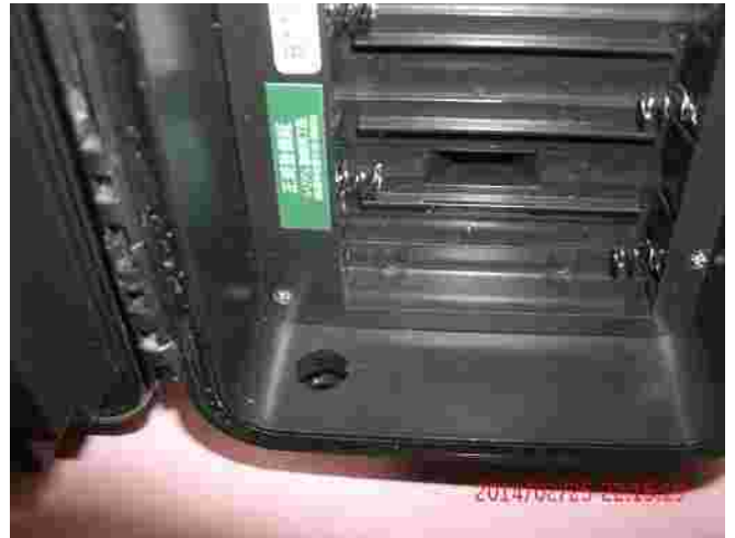
外部電源用穴 内面から
