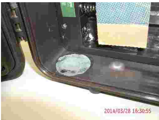
セメダインスーパーXで貼りなおし 基板のナイロン繊維にしみこむので通気確保の面には接着剤がつかないように注意
