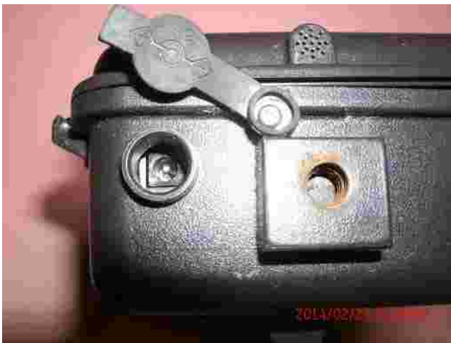
外部電源用穴 ゴムキャップがついているが脱落しやすい 防塵・防水構造が保てない
