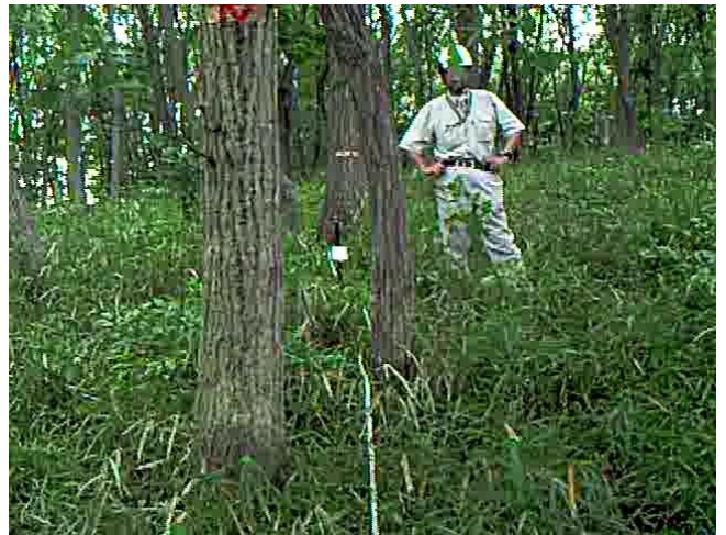
模擬設置状況 センサーカメラトローフィーカムXLT HT-カメラ間距離が狭すぎてフレームアウト
