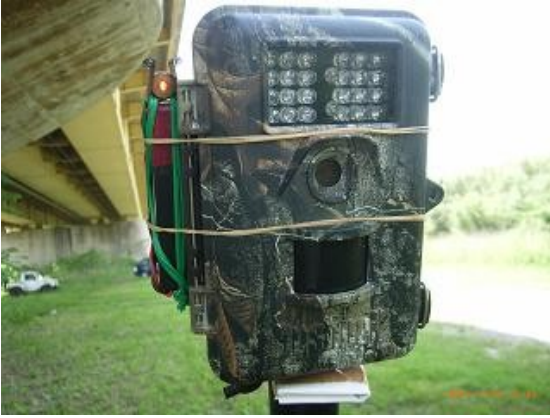
参考 半導体レーザー照準01 平地実験 この模擬設置に使用したカメラにはビューワーが付属していなかったため、光軸の確認補助のために使用した。ビューワーで確認可能であれば必ずしも必要ではない。
