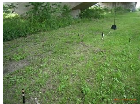
HT 2m四辺形の平面上での配置状態 外観 Ht中心-カメラ距離 3.9m カメラ高 1.5m 俯角 約22-25度
