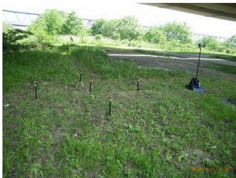
HT 2m四方の正方形の平面上での配置状態 外観 Ht中心-カメラ距離 3.9m カメラ高 1.5m 俯角 22-25度
