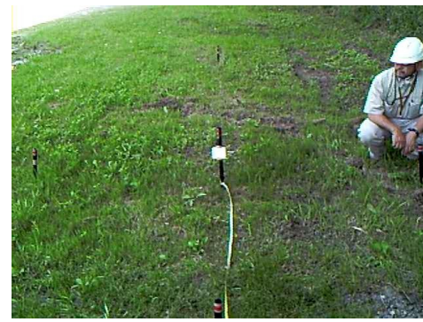
HT 2m四辺形の平面上での配置状態 カメラからの視野
