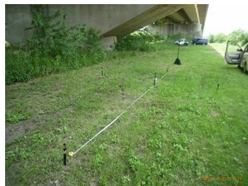
HT 3m四辺形の平面上での配置状態 外観 Ht中心-カメラ距離 6.0m カメラ高 1.5m 俯角 約22-25度
