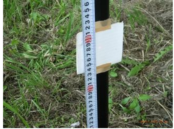
参考 半導体レーザー照準02 平地実験 事前にカメラの光軸と一致するかどうか確認が必要。だが、カメラの器差があるようで、ひとつの照準器で複数台数に適應できるか疑問あり。カメラの工作精度・公差が不明のため。
