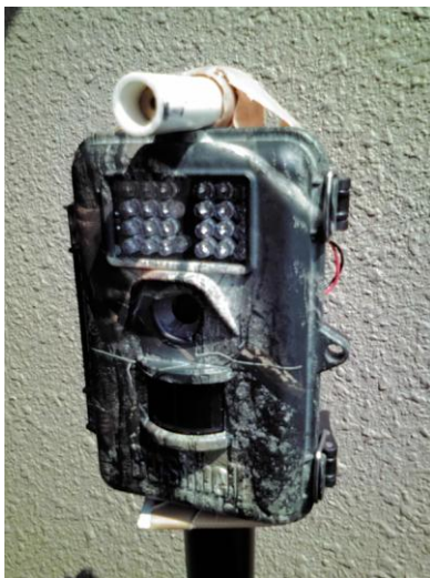
写真 3-1 半導体レーザー発振器ユニット （秋月電子通商）を筒に収納して仮止。
