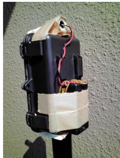
写真 3-2 背面電池ボックス 3V で 駆動。仮止。
